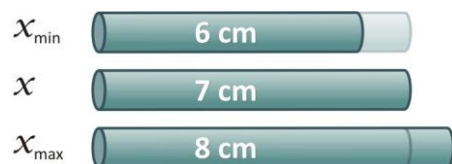
Figure 10. Illustration des valeurs minimale et maximale de la mesure d'une longueur selon son incertitude absolue
